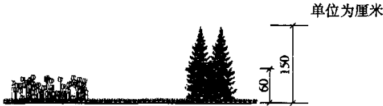
图4 中央分隔带绿化设计立面图示例
