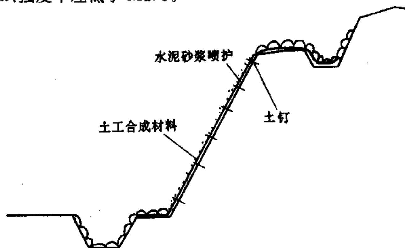
图 6.2.8 岩石边坡防护施工
